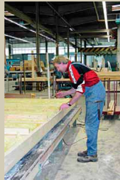
Mit seiner Holzrahmenbauweise setzt der Nordhorner Fertighauspezialist auf ein ökologisches und wohngesundes Material als Herzstück eines jeden GUSSEK-Hauses. Die einzelnen Elemente der Entwürfe werden dabei trocken und sicher im Werk vorgefertigt und erst auf der Baustelle montiert. So hat Feuchtigkeit in den Bauteilen des neuen Eigenheims von vornherein keine Chance.
