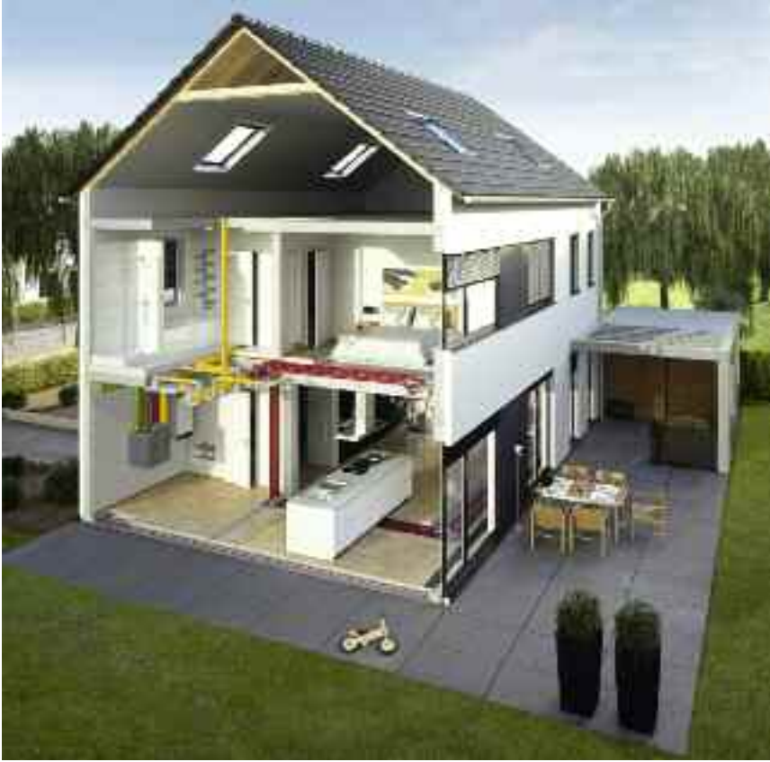
Eine zentrale Lüftung mit Wärmerückgewinnung senkt die Heizkosten und sorgt für gutes Raumklima.
