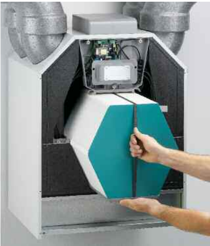
Im zentralen Lüftungsgerät gibt die verbrauchte Raumluft ihre Wärme an die Frischluft ab.
